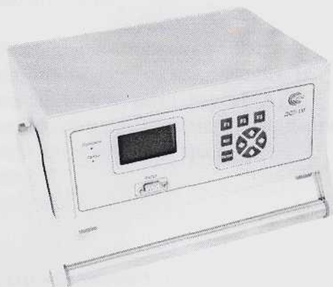
Рис 1 Внешний вид прибора для измерения параметров холостого хода силовых трансформаторов ДСТ-1М
