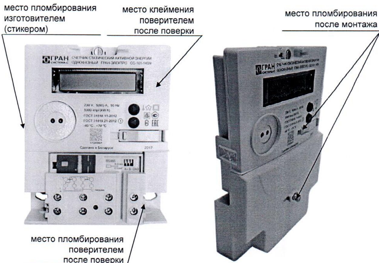
Рисунок А.3 – Места клеймения и пломбирования счетчиков модификации «Гран-Электро СС-101-XXXX», а) после поверки (вид со снятой крышкой зажимов), б) после монтажа (вид с установленной крышкой зажимов)
