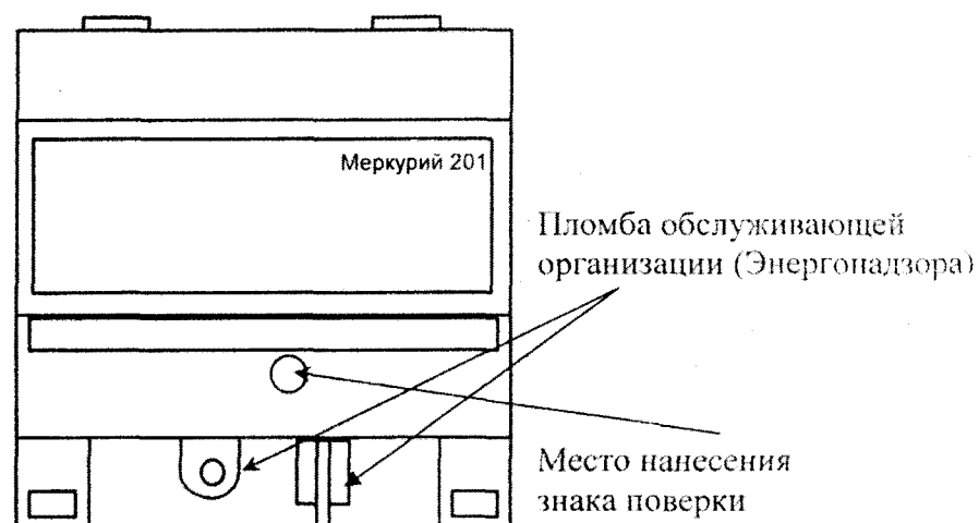
Рисунок 5 – Схема пломбировки от несанкционированного доступа, обозначение места нанесения знака поверки счётчиков «Меркурий 201.7», «Меркурий 201.8», «Меркурий 201.82», «Меркурий 201.9»
