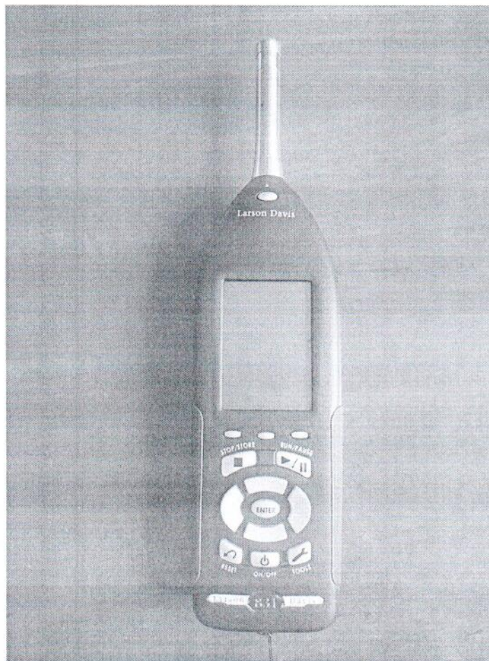
Рисунок 1.1 – Фотография общего вида шумомера Larson Davis 831 № 0004633
