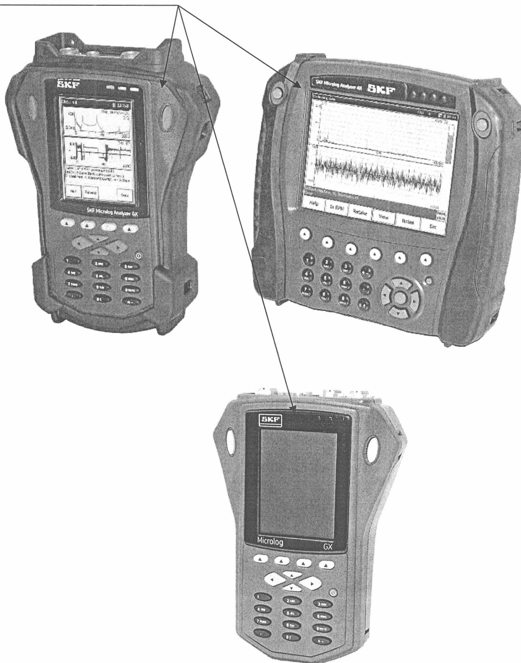
Рисунок А.1 – Схема с указанием места нанесения знака поверки (клейма-наклейки) на анализаторы
