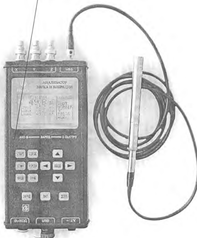
Рисунок А.2 – Место нанесения знака поверки (лицевая панель прибора)
