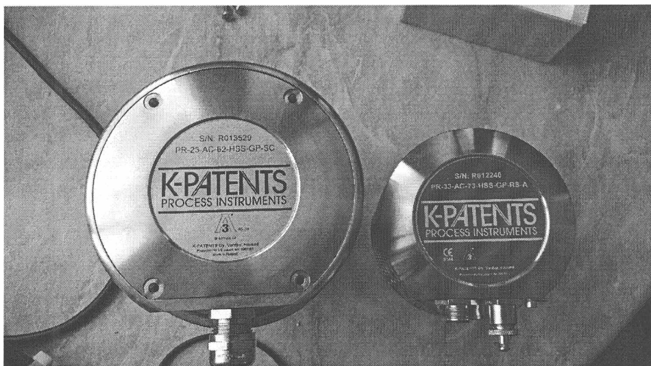
Рисунок 2 – Внешний вид датчиков рефрактометров промышленных K-Patents серии PR
