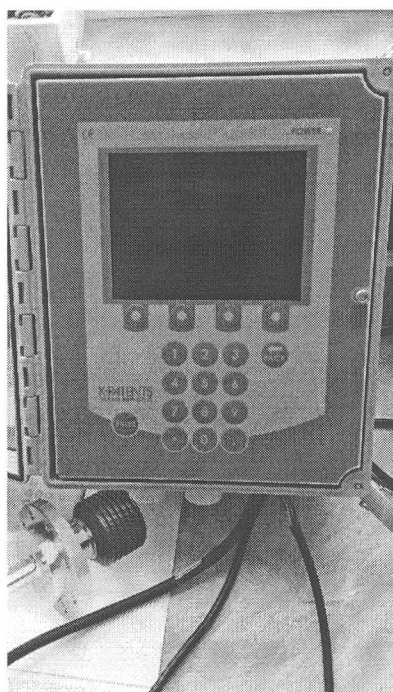
Рисунок 1 – Внешний вид рефрактометров промышленных K-Patents серии PR модификации PR-23
