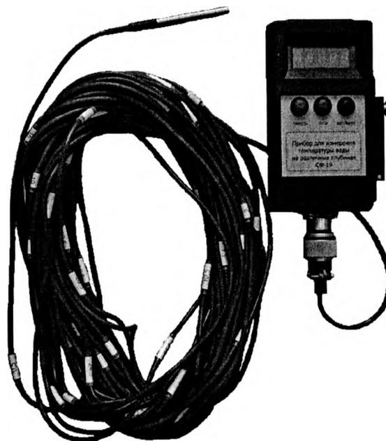
Рисунок 1 – Прибор для измерения температуры воды на различных глубинах СФ-19.
