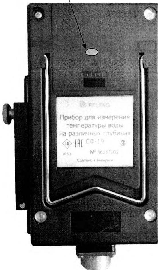
Рисунок А.1 – Схема с указанием места нанесения знака поверки (клейма-наклейки) на прибор
