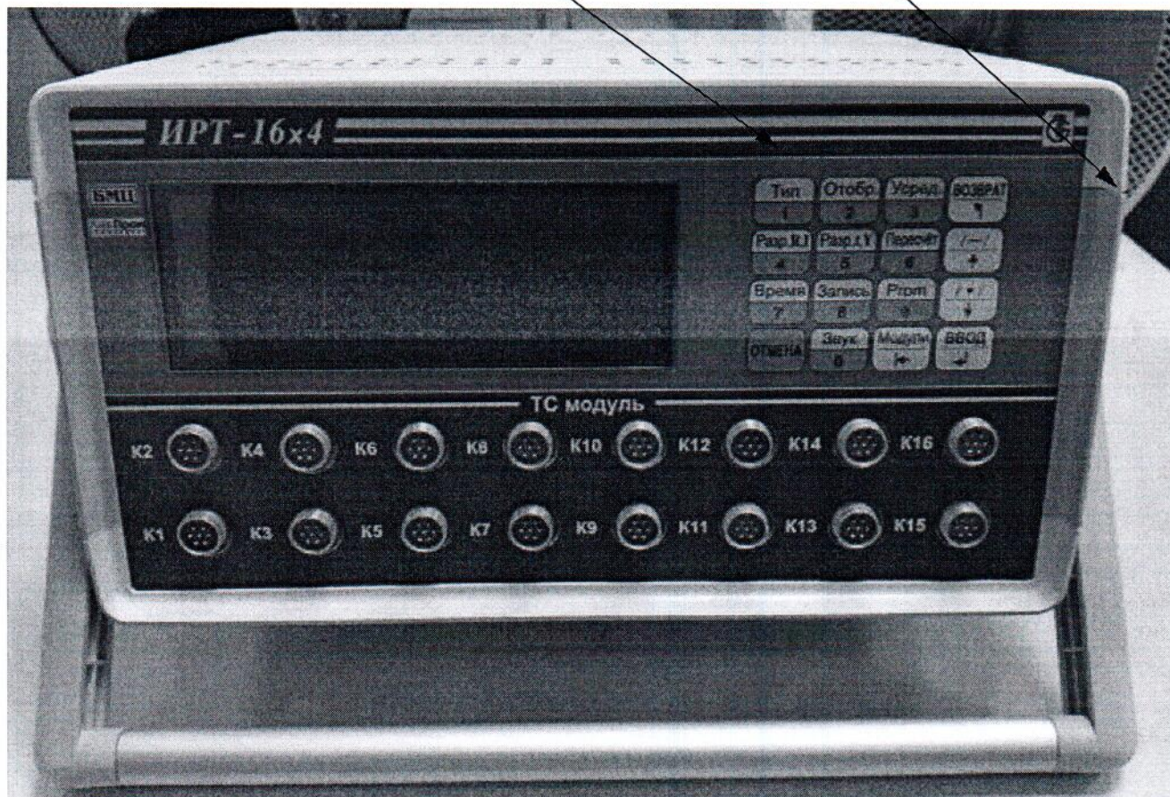
Рисунок А.1 – Схема пломбировки измерителей-регистраторов изготовителем с указанием места для нанесения знака поверки в виде клейма-наклейки
