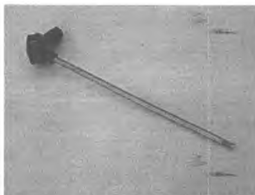
Рис.2 - ТП модификация ТХА-К/ТХК-К.105
