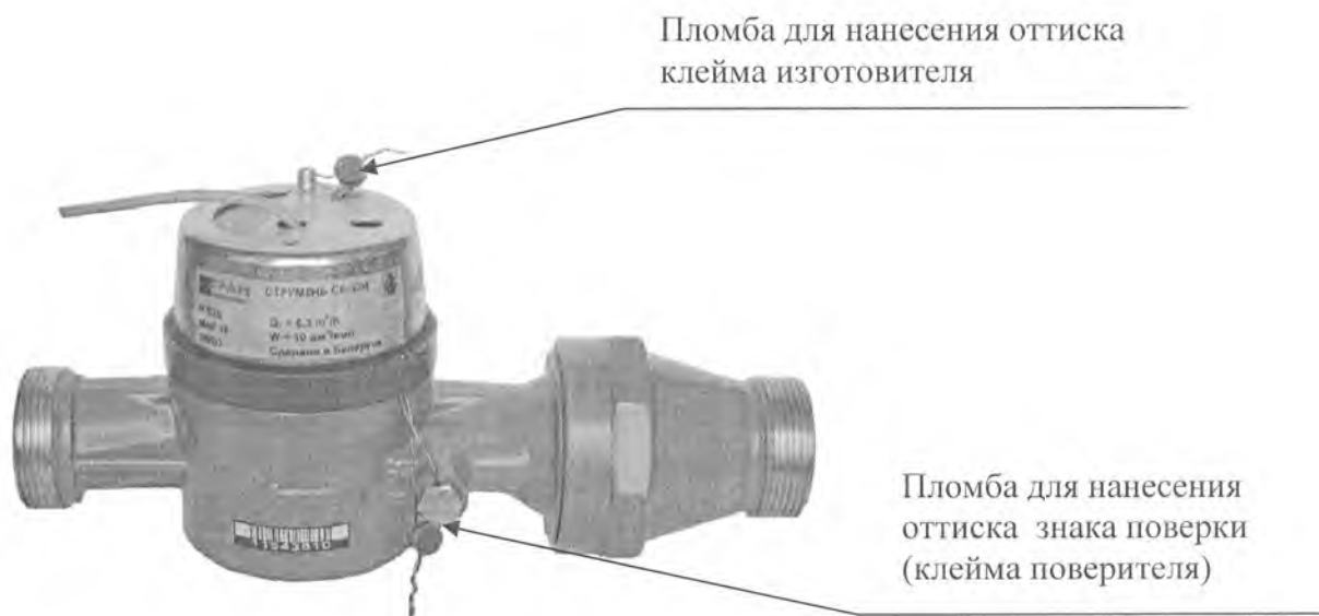
Рисунок А.5 – Места нанесения оттиска знака поверки и пломбирование счетчиков воды СВ-32 «СТРУМЕНЬ», СВ-40 «СТРУМЕНЬ» СВХ-15 «СТРУМЕНЬ-ГРАН», СВГ-15 «СТРУМЕНЬ-ГРАН», JS, MWN
