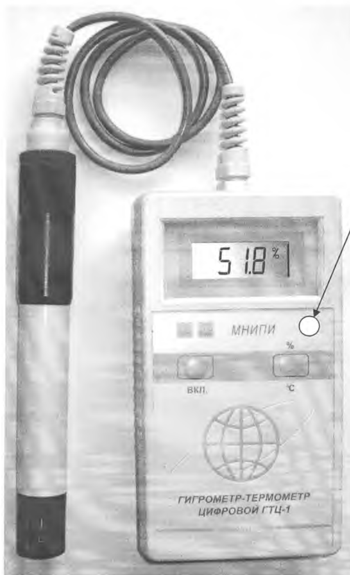
Рисунок А.1 – Внешний вид гигрометра-термометра цифрового ГТЦ-1 и место нанесения знака поверки (клейма-наклейки)
