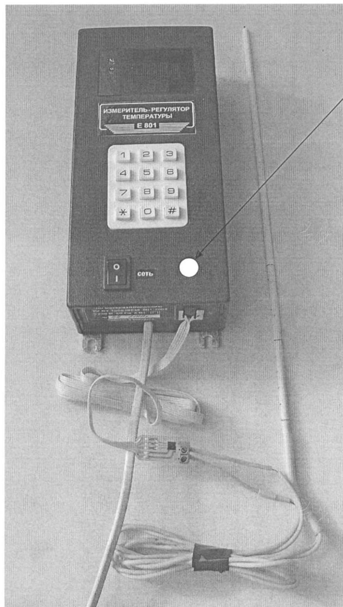
Рисунок А.1 – Внешний вид измерителя-регулятора температуры Е801
