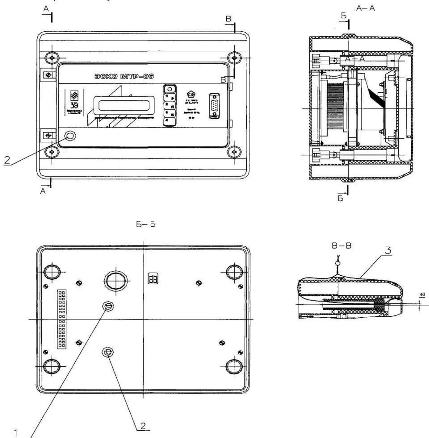
1, 2 – Места нанесения знака поверки (клейма-наклейки) на теплосчетчик
