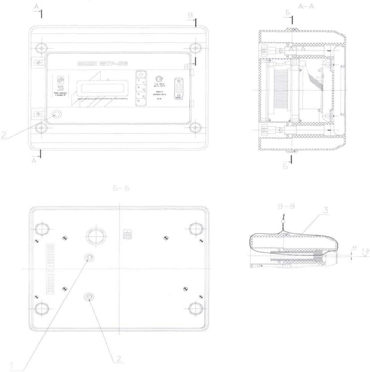
1, 2 – места нанесения на теплосчетчик клейма- наклейки
