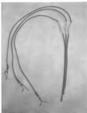
Рисунок 1 – Преобразователи термоэлектрические многозонные ТХА Метран-261, ТХК Метран-262
