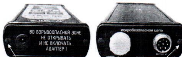
Пломбировка углублений с крепежными винтами пластикой FIMO с последующим оттиском клейма
