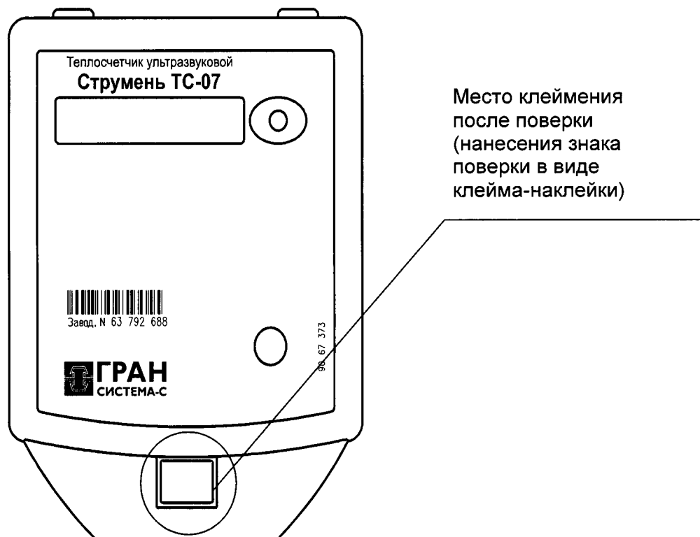
Рисунок А.3 – Схема с указанием мест клеймения тепловычислителя теплосчетчика модификации «СТРУМЕНЬ TC-07-K50»
