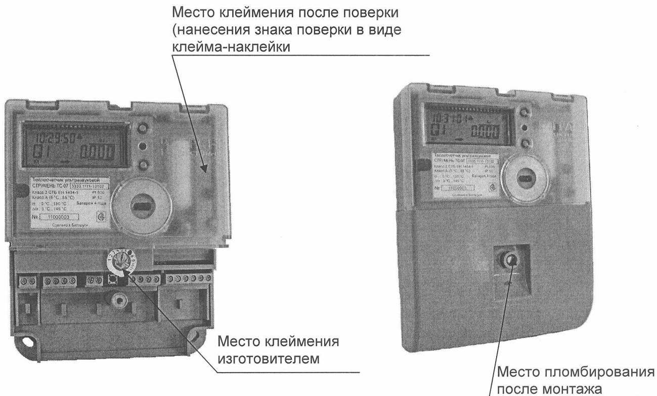
Рисунок А.1 – Схема с указанием мест пломбирования и клеймения тепловычислителя теплосчетчика модификации «СТРУМЕНЬ TC-07»
