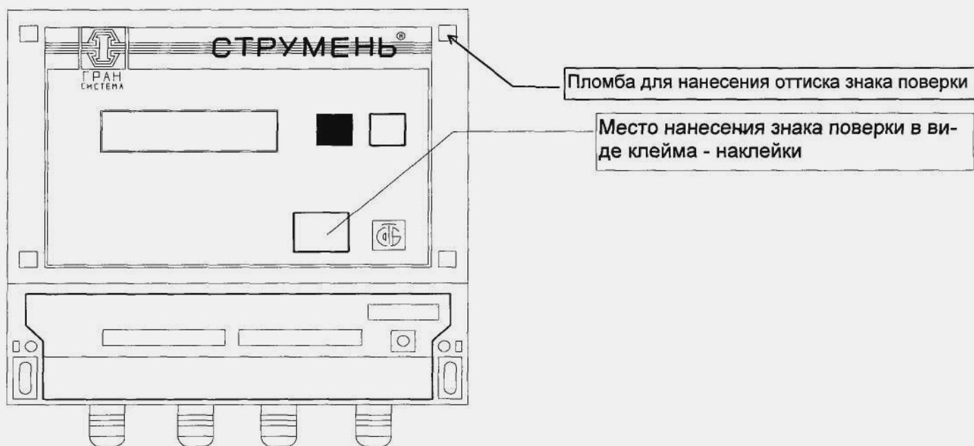
Рисунок Б.2 - Место нанесения знака поверки в виде клейма-наклейки и пломбы с оттиском знака поверки на ТВ «обычного» исполнения ТС модификации «СТРУМЕНЬ ТС 07 XX.X-XXX»
