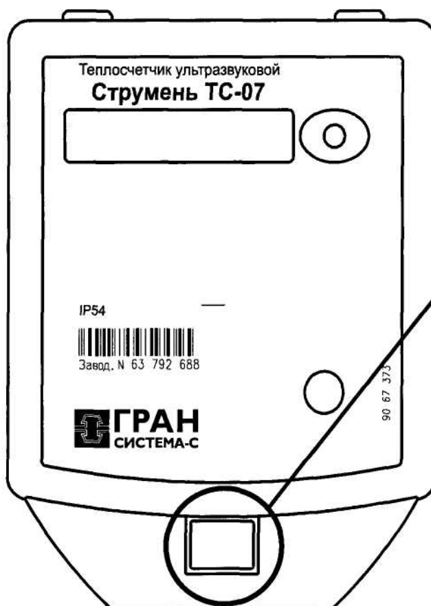
Рисунок Б.4 Место нанесения знака поверки в виде клейма наклейки на ТВ «компактного» исполнения ТС модификации «СТРУМЕНЬ TC 07 XX.X-XXXX-K6»
