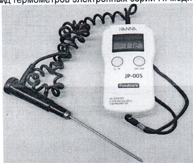
Рисунок 6 – Внешний вид термометров электронных серии HI модификации HI 935007
