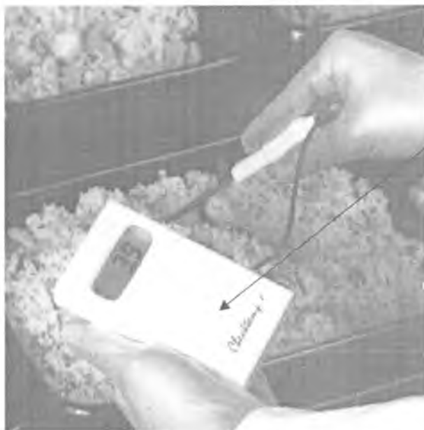
Рисунок А.2. Место нанесения знака поверки в виде клейма-наклейки на термометр НІ 98509 Checktemp 1
