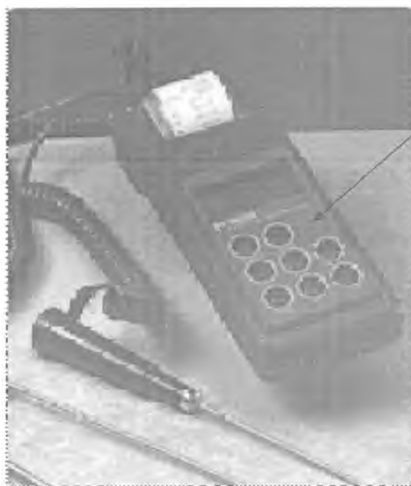
Рисунок А.7. Место нанесения знака поверки в виде клейма-наклейки на термометры HI 98801, HI 98804.
