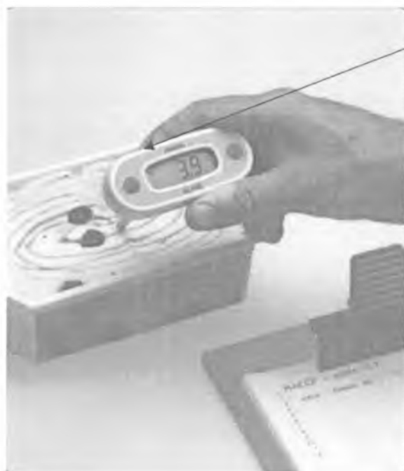
Рисунок А.3. Место нанесения знака поверки в виде клейма-наклейки на термометр HI 145-00.
