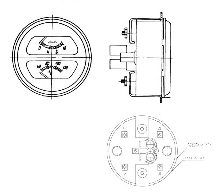
Рисунок А.1 - Общий вид, обозначение места для нанесения оттисков клейм
