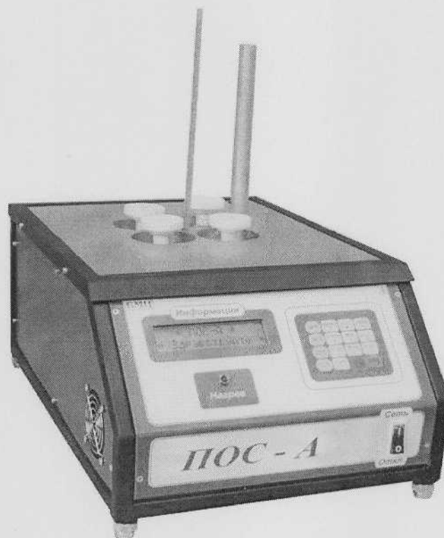
Рис. 1 Внешний вид устройства термостатирующего измерительного «ПОС-А»
