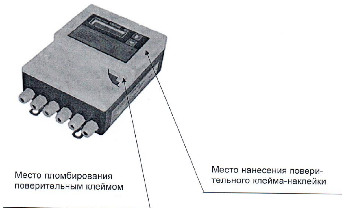
Рисунок А.1 Схема указания места пломбирования и места нанесения знака поверки (клейма-наклейки)
