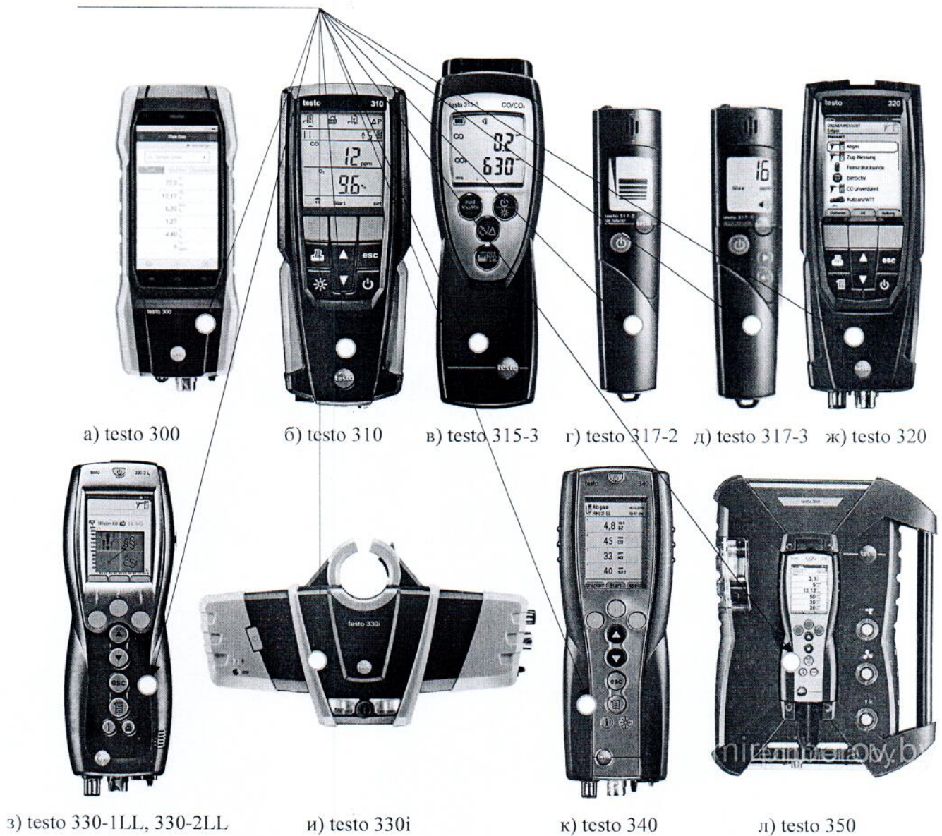
Рисунок 2.1 – Схема (рисунок) с указанием места для нанесения знака поверки (изображение носит иллюстративный характер)
