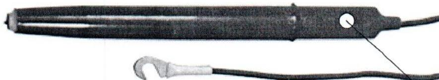
Место нанесения знака поверки при нанесении методом наклеивания
