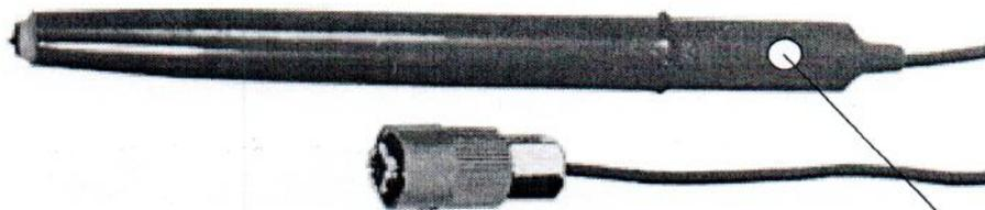
Место нанесения знака поверки при нанесении методом наклеивания
