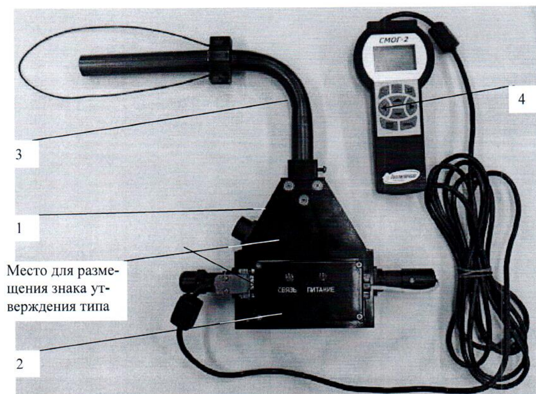
1 – измерительная камера; 2 – БОИ; 3 – пробозаборник; 4 – БПИ
