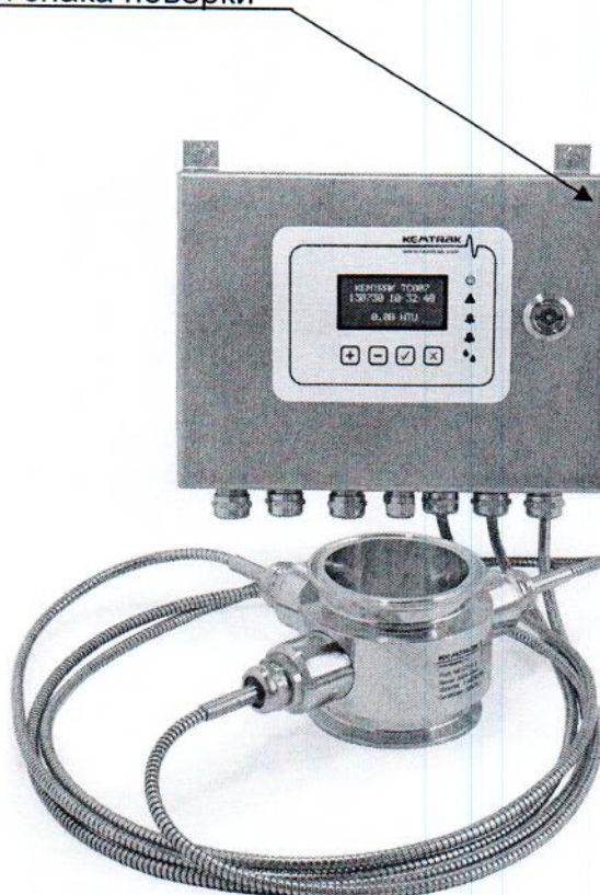
Рисунок 4 - Место нанесения знака поверки на анализатор промышленный Kemtrak серии xxx007 (модификация TSP007)
