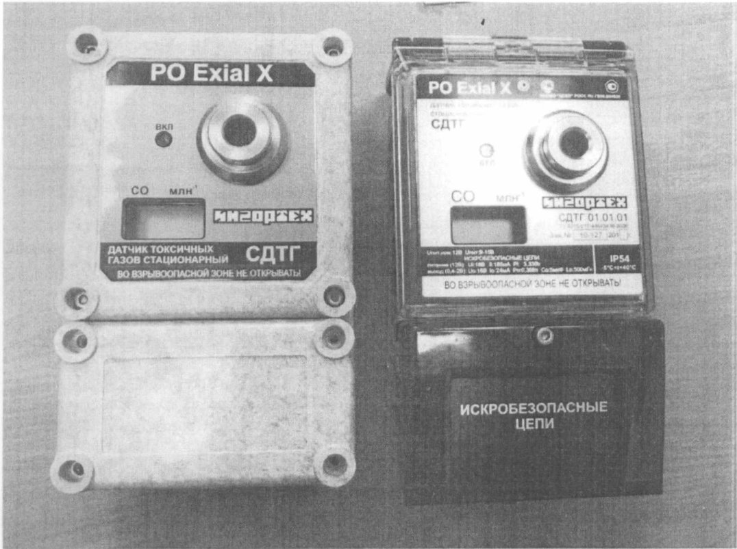
Рисунок 1 - Датчики токсичных газов стационарные СДТГ (на примере СДТГ 01, два варианта исполнения корпуса)
