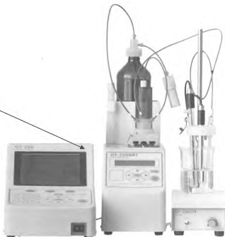
Рисунок 1. Схема нанесения поверочного клейма-наклейки
