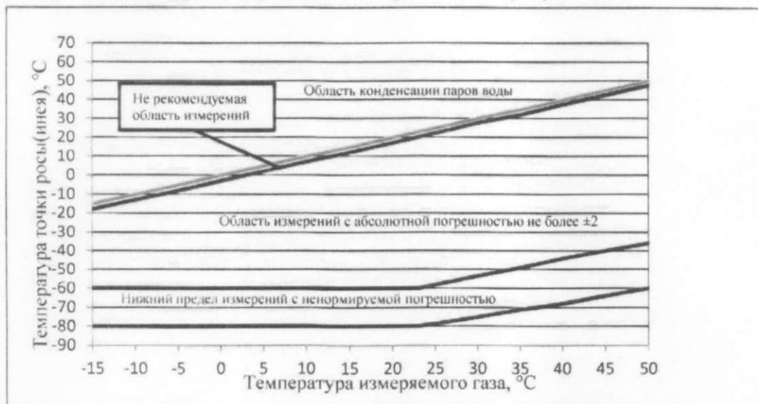
Рисунок 2 – Зависимость диапазона и абсолютной погрешности измерений температуры точки росы (инея) от температуры измеряемого газа
