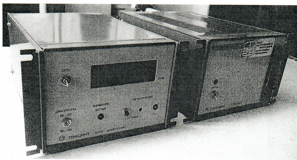
Рисунок 3 - Газоанализатор ГИАЦИНТ. Блок измерения. Датчик. Схема пломбирования от несанкционированного доступа
