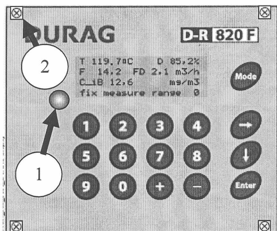
Схема 1 Расположение клейма-наклейки (1) на лицевой панели D-R 820 F и место пломбировки (2).
