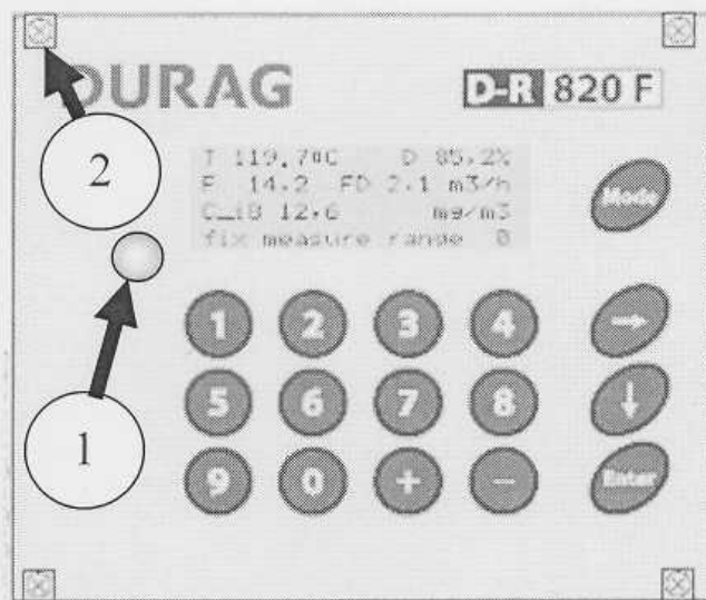
Схема 1 Расположение клейма-наклейки (1) на лицевой панели D-R 820 F и место пломбировки (2).
