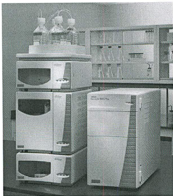
Хроматограф жидкостный Surveyor Plus с масс-селективным детектором MSQ Plus
