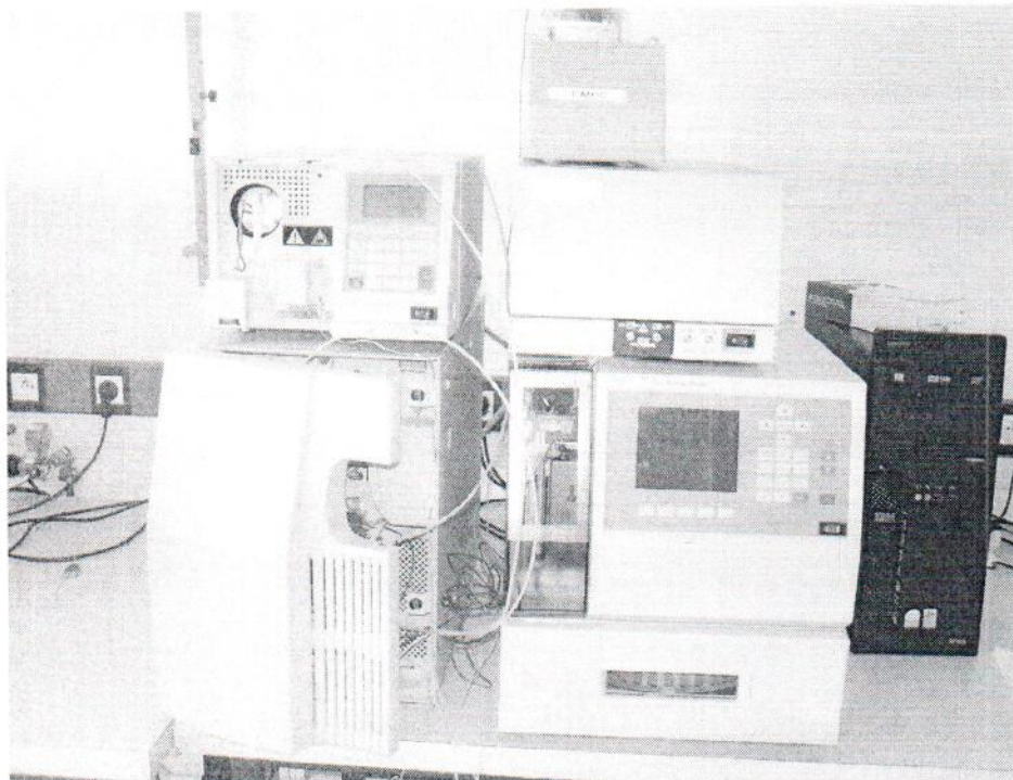
Рисунок 2 – автосамплер 717, градиентный насос 1525, диодно-матричный детектор 2996, флуоресцентный детектор 2475
