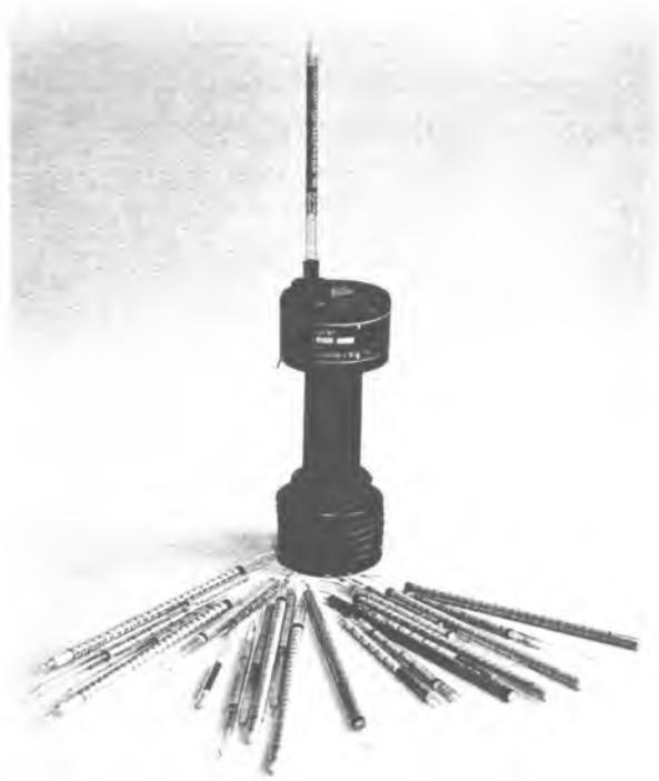
Рисунок 1. Внешний вид аспираторов сильфонных АМ-0059.
