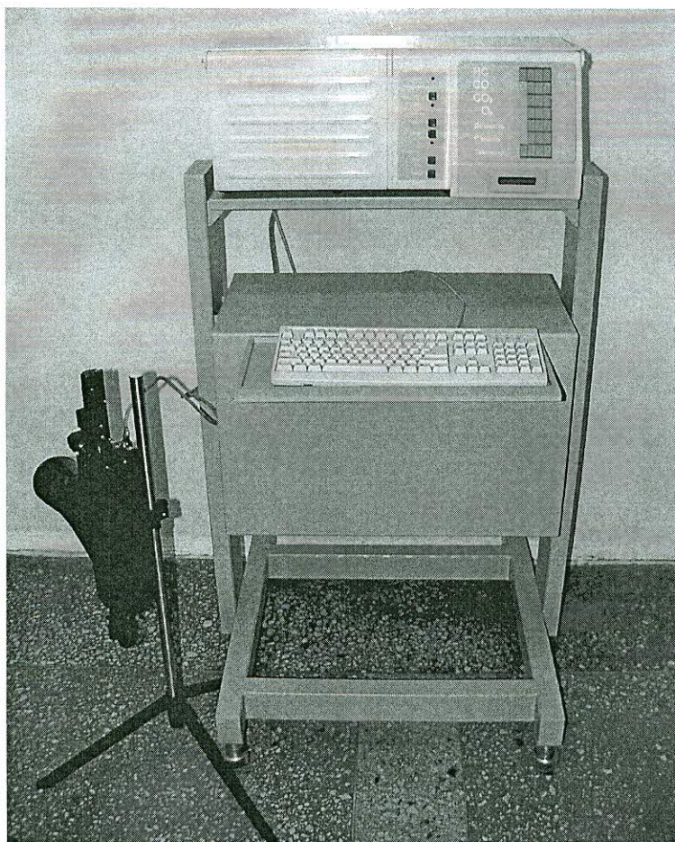
Рисунок 1 – Внешний вид комплекта аппаратуры для измерения параметров двигателей внутреннего сгорания «Пеленг СК-02»
