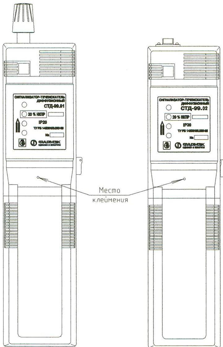
Рисунок 1. Место нанесения оттиска поверительного клейма
