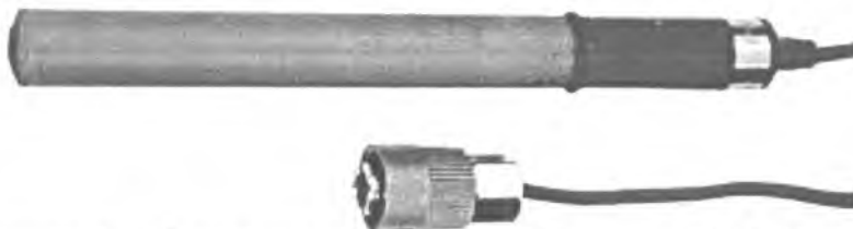
Рисунок 2 – Общий вид электрода мембранного ЭМ-NO 3 -07CP
