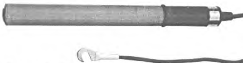
Рисунок 1 – Общий вид электрода мембранного ЭМ-NO 3 -07
