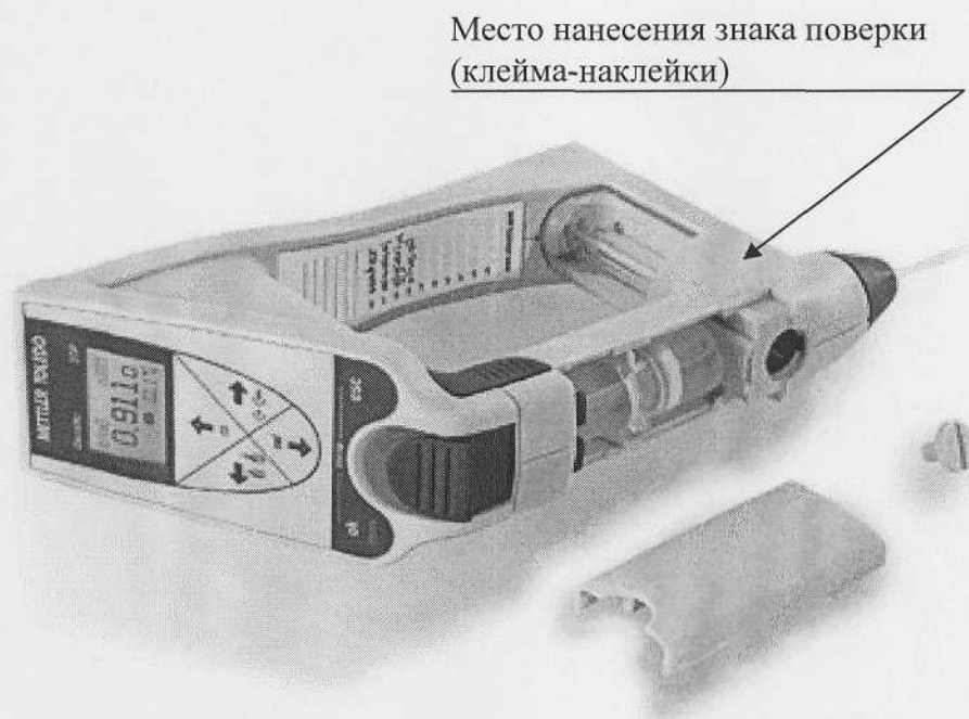
Рисунок А.3 Внешний вид плотномера Densito 30PX и место нанесения знака поверки
