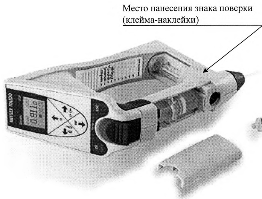
Рисунок А.3 Внешний вид плотномера Densito 30PX и место нанесения знака поверки
