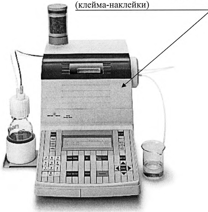
Рисунок А.2 Внешний вид плотномеров DE40, DE45DR, DE51 и место нанесения знака поверки
