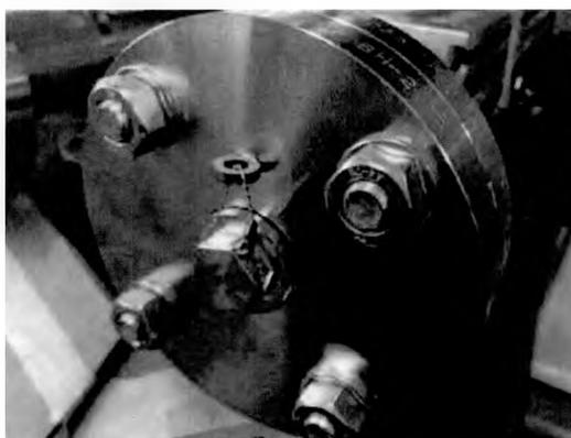
Рисунок 5 – Варианты пломбирования корпуса уровнемера BNA пломбой поверителя
