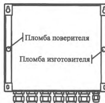
Корректор СПГ762. Вид сзади. Схема пломбирования
