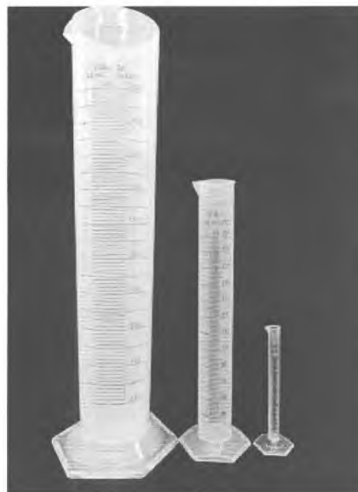
б) Цилиндры мерные градуированные пластиковые VITLAB, РР, класс В, высокие, рельефная шкала синего цвета
