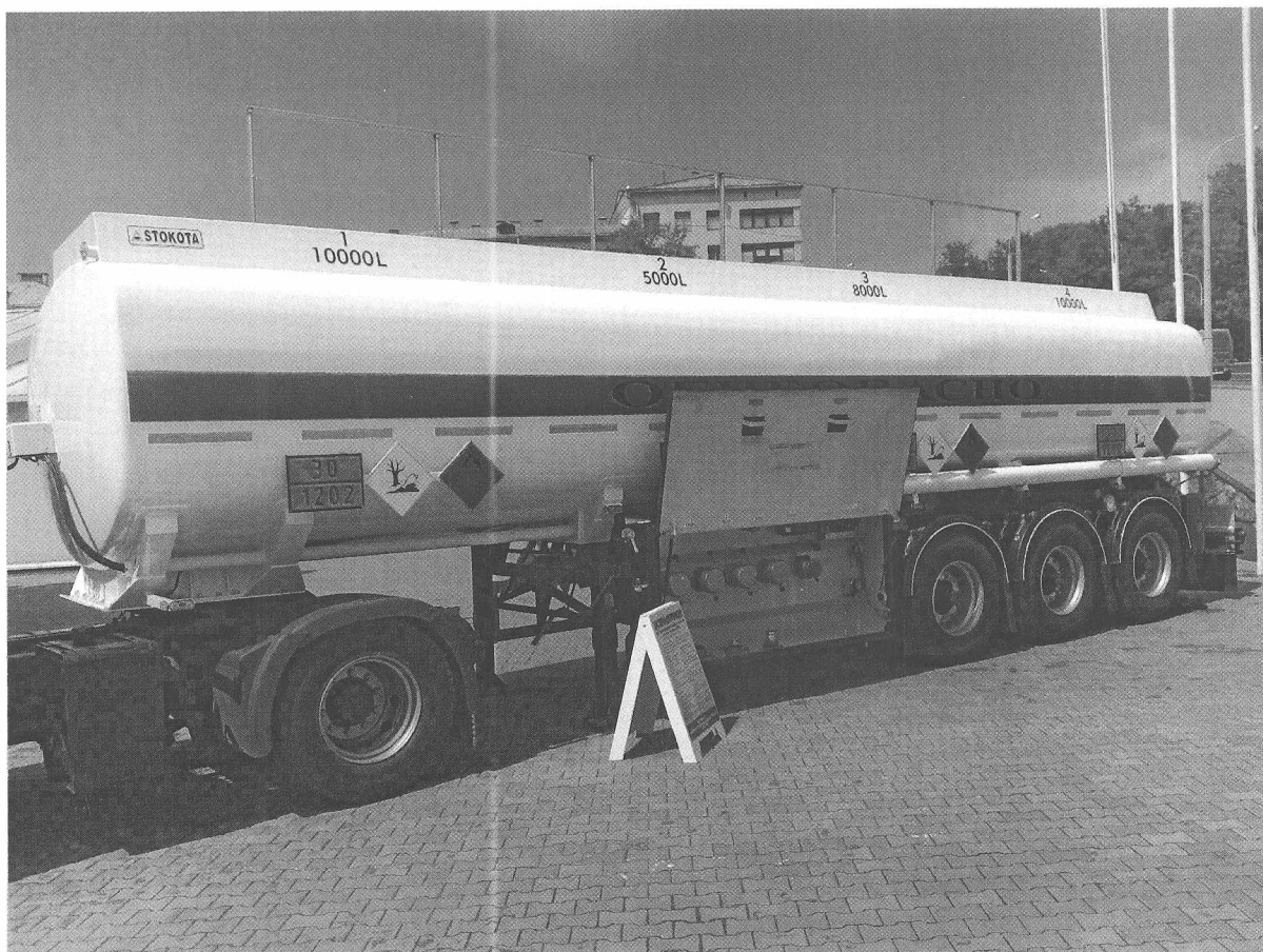
Рис.1. Внешний вид полуприцепа-цистерны OPL38-3/FUE.
