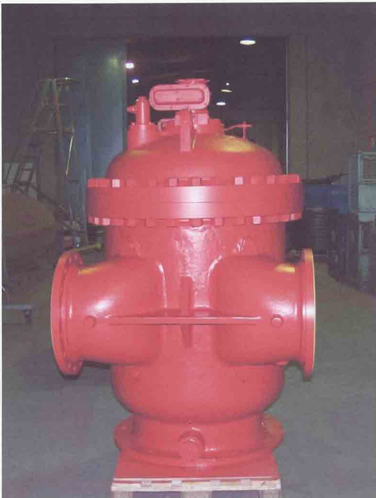
Объемный лопастной камерный расходомер модель М16 с датчиком импульсов
