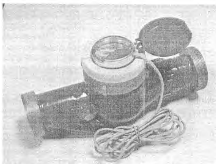
Рисунок 2. Внешний вид счетчика холодной воды крыльчатого МТК-50N с установленным герконовым датчиком и защитной крышкой.
