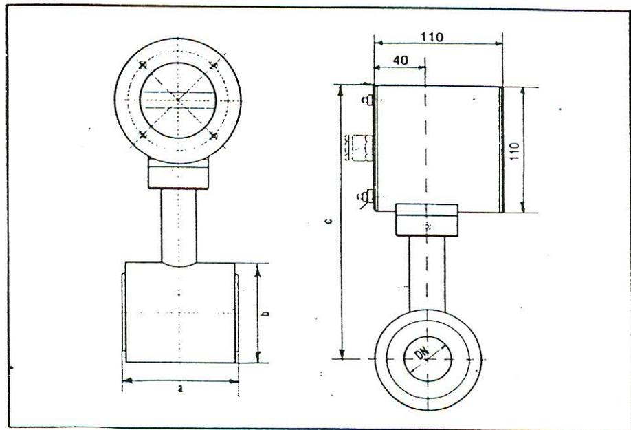
Рис. 1 Габаритные размеры МР 400.
