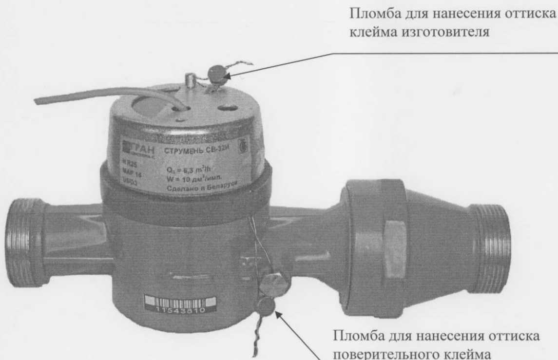
Рисунок А.2 – Места клеймения и пломбирования счетчиков СВ-32И «СТРУМЕНЬ», СВ-40И «СТРУМЕНЬ»
